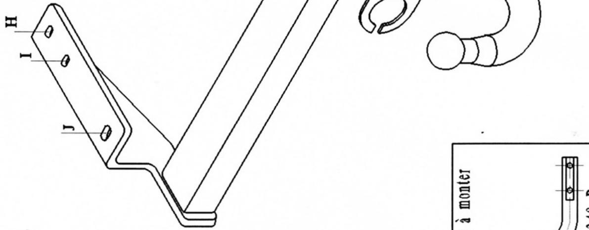
**REMARQUE:** Le trou oblong supérieur du support faisceau sert à la fixation sur l'attelage et celui inférieur à accrocher le câble de sécurité
