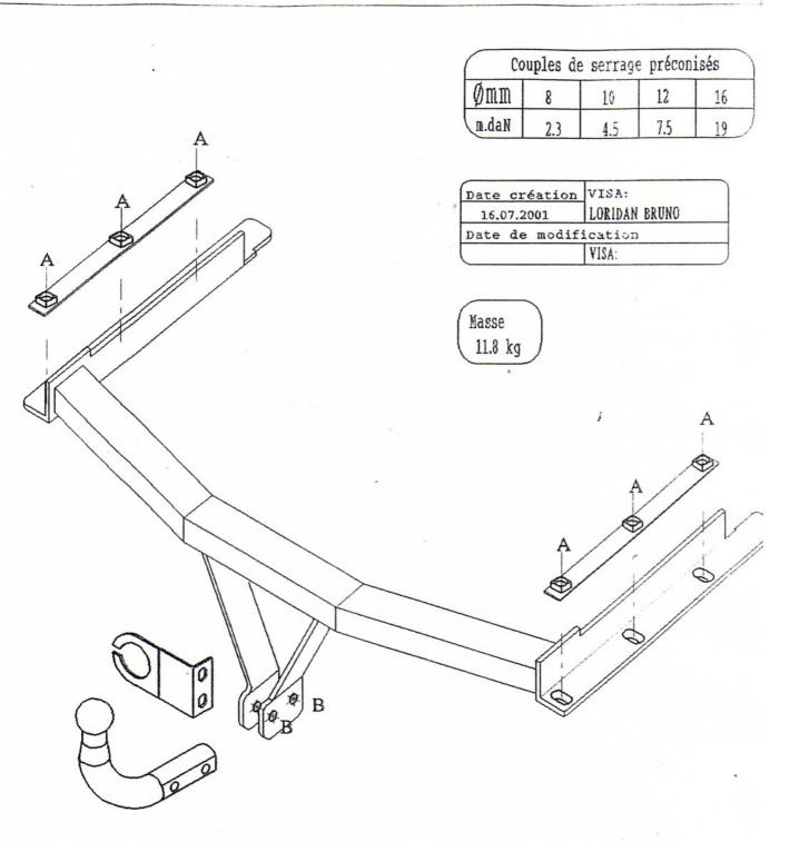
ATTENTION: Sur le support faisceau, le trou oblong supérieur sert à la fixation sur l'attelage et celui inférieur à accrocher le cable de sécurité.
